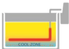
La "zone froide" située sous la résistance permet aux résidus d'aliments qui tombent dans le fond de la friteuse, de ne pas carboniser.
